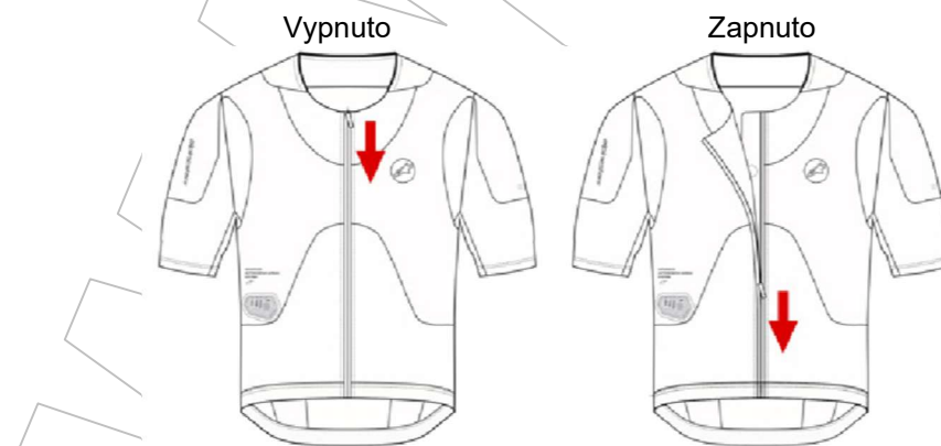
Obrázek 11: Systém se vypne, když je aktivační zip (2) otevřený
